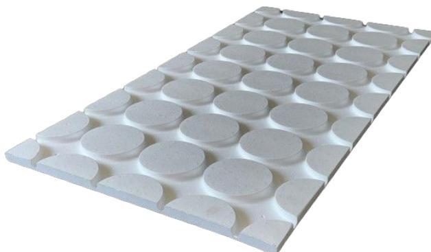
Das **Kreiselement Ardus EPS 300** wird im Trockenbau verwendet und dient als Träger für Heizrohre. Das Element besteht aus EPS 300 kPa. Die Heizungsrohre lassen sich in Schneckenform (Spiralform) verlegen. Das Element ist in Plattenstärken von 20, 25 bis 30 mm verfügbar, jeweils mit einem Verlegeabstand von 150 oder 200 mm. Das System zeichnet sich durch sein leichtes Gewicht und seine flache Aufbauhöhe aus.
